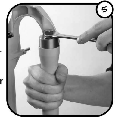
Utiliser l'outil spécifique afin d'enlever les bagues de guidage
