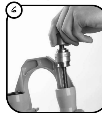
Tourner l'outil dans le sens des aiguilles d'une montre afin de sortir les bagues
