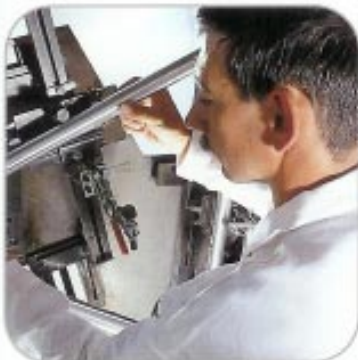
Mise en place des tubes sur gabarit avant soudage TIG.
