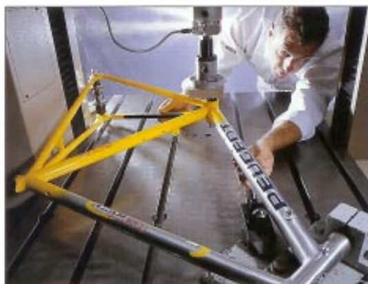
Test rigidité : Boîte de pédalier sur cadre course.
