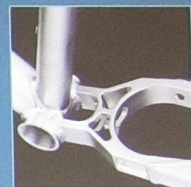
YOKE INFERIORE Passaggio ruota ricavato da pieno in CNC. Foderi orizzontali di sezione rettangolare a triplo spessore
