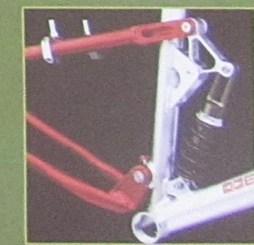
AMMORTIZZATORE Tipo "Trough Shaft". È realizzato in collaborazione con la "Fly". Freno idraulico differenziato tra compressione ed estensione. Regolazione di damping.
