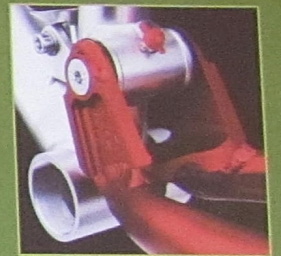
FULCRO PRIMARIO Lavorazione in CNC e movimento della sospensione su cuscinetti a rulli.
