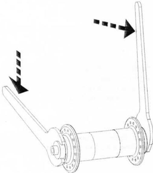
1. Svitare il tappo mobile in ERGAL con l'ausilio di due chiavi ribassate da 15 mm.
