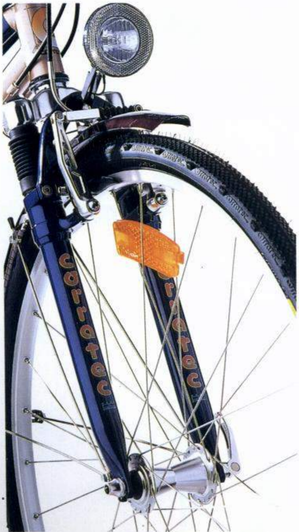
Wartungsfreie Elastomer Federgabel
