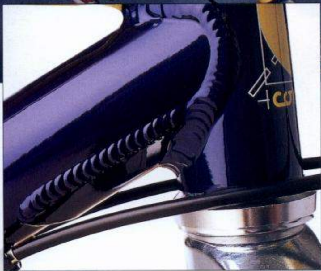
Rahmenverstärkung für Trial Extrem-Belastungen
