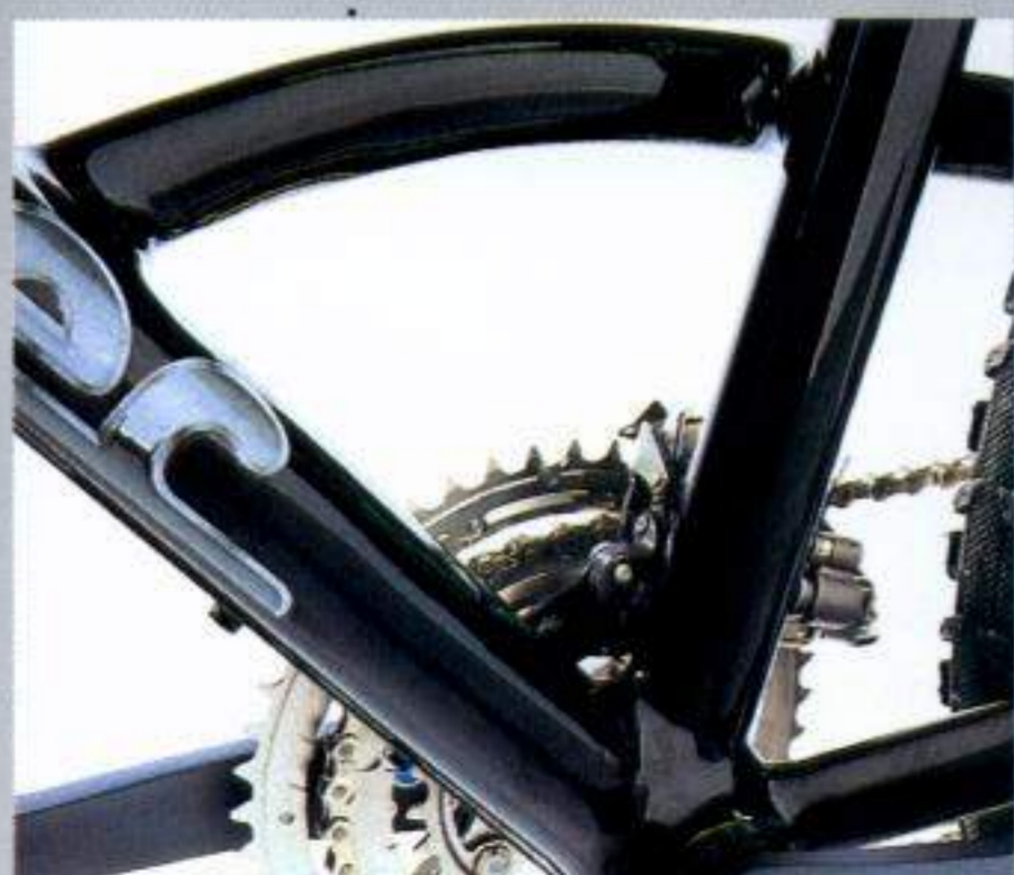
Rechts, hochgezogene Kettenstrebe für freie Kettenführung
