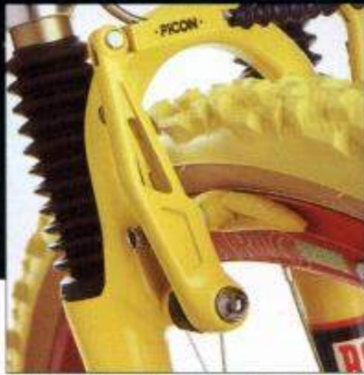
Verstärkte Bremsleistung durch längere Bremsarme.
