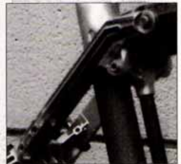
Die Muffen sind aus 7075-T6 Aluminium CNC gefräst. Wert: 30.000,00 DM
