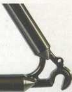
Hinterbau mit Finesse: Asymmetrische Kettenstreben, filigrane CNC-gefräste Ausfallenden
