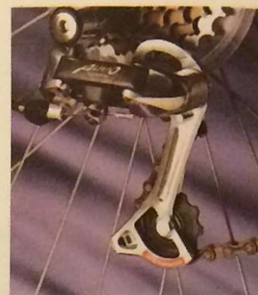
▼ Shimano Alivio front and rear derailleurs
