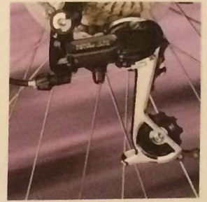
▼ Deore LX rear derailleur & Parallax hubs
