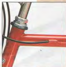
Innenverlegte Kabelzüge am Oberrohr.
