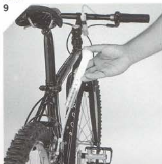
9 Mit der Spritze wird Öl durch das System gedrückt. Oil is pushed through the system with the syringe and the attached filler tube.
