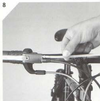
8 Eindrehen des Entlüftungsschlauches. Temporary installation of the brake lever venting tube.
