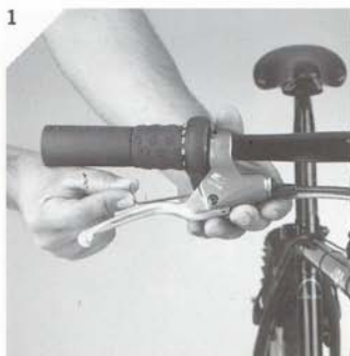
1 Nachstellen der Bremsbeläge. Readjusting the brake pads
