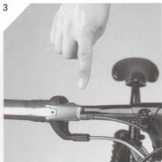
Beim Befüllen an höchster Stelle: Die Entlüftungsschraube. The bleed screw at the highest point of the system.
