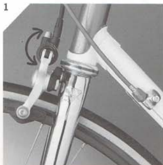
1 Rändelschraube zur Einstellung des Belags- abstandes bei der HS 77.
