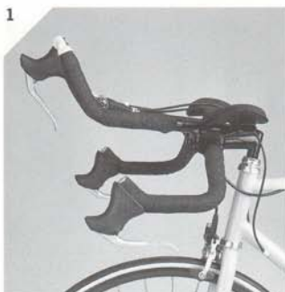
1 HS 77-Kombination für Triathlon. HS 77 triathlon application. Use the MAGURA Tria-Kit.
