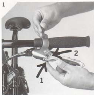
HS 22 angebaut mit STI-Adapter. Fixierung mit Inbus SW 4.
