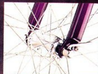
Aluminium Vorderradnabe mit Schnellspanner
