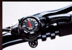
Shimano Schalthebel mit optischer Ganganzeige
