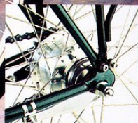
Wartungsfreie Shimano 7 Gang Nabe mit Rücktrittbremse
