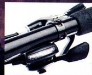
Alivio Rapidfire Plus Schalthebel mit optischer Ganganzeige
