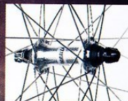
Shimano Alivio Parallax Naben mit Schnellspannern
