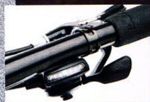
Alivio Rapidfire Plus Schalthebel mit optischer Ganganzeige
