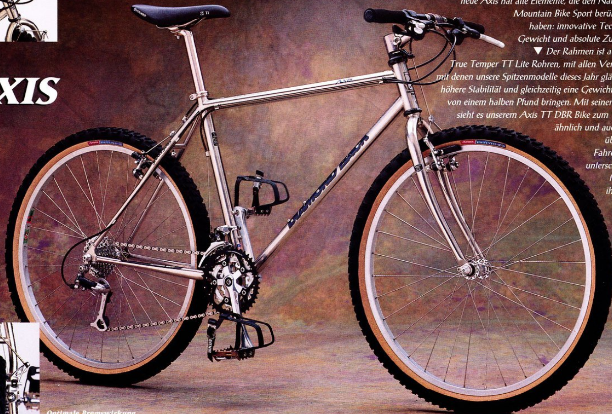
Optimale Bremswirkung durch "Snake Stays" und Deore XT Bremsen
