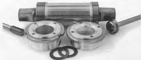
Titan-Tretlager Ac 24 3-fach gelagert, unzerstörbar durch Vorspannung
