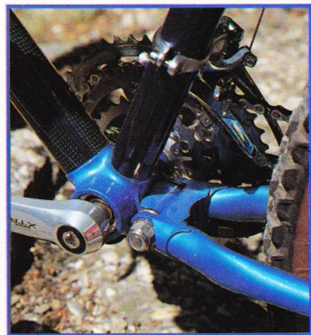
Scharnierpunt vlak achter het alu bracket.
