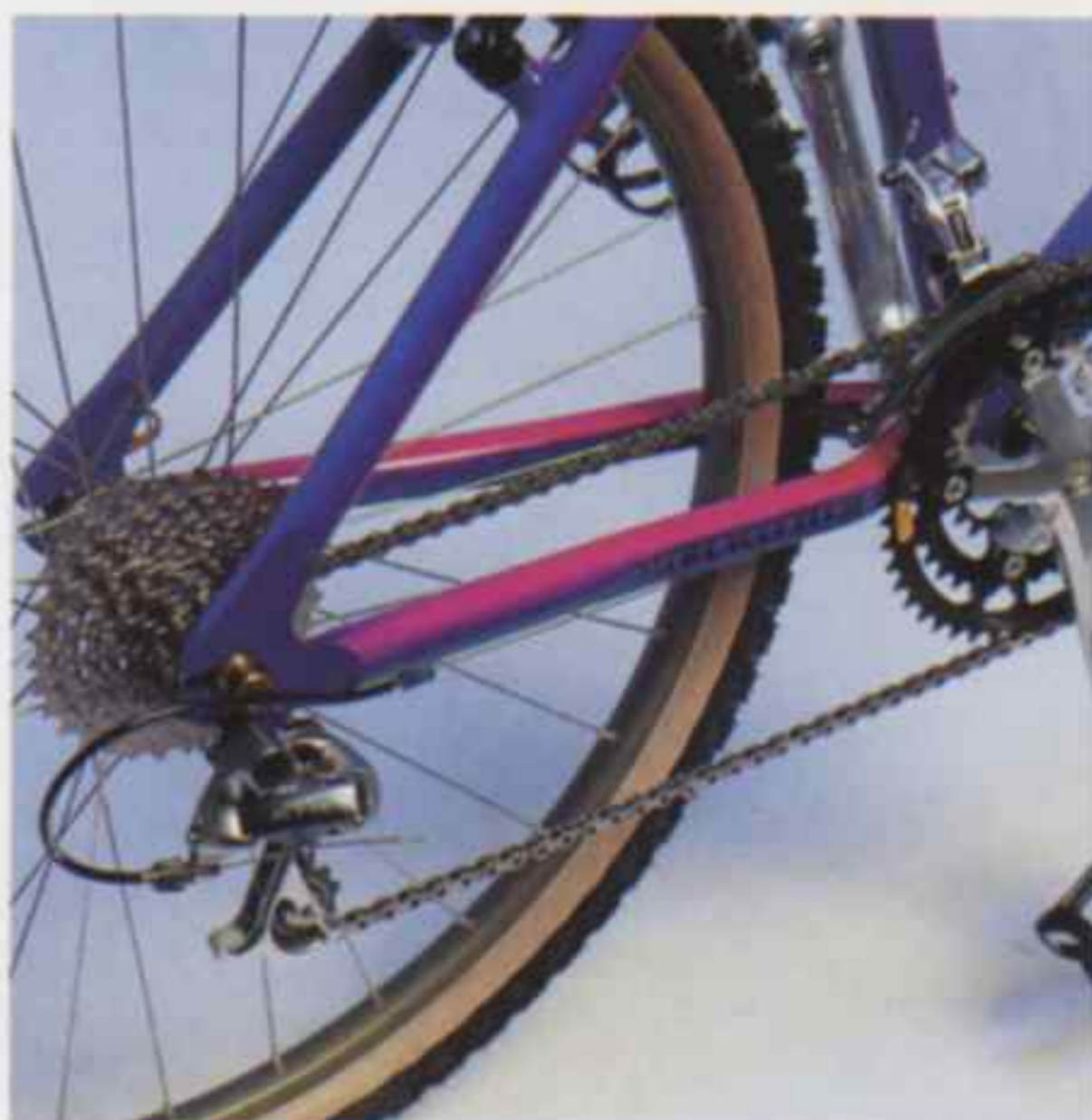
Kurze, am Tretlager vierkantige, beim Ausfallende runde Kettenstreben. Gewöhnungsbedürftig ist, dass das Hinterrad horizontal ins Ausfallende eingeführt werden muss.
