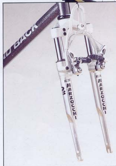
Marzocchi XC-200 Hydraulic Suspension
