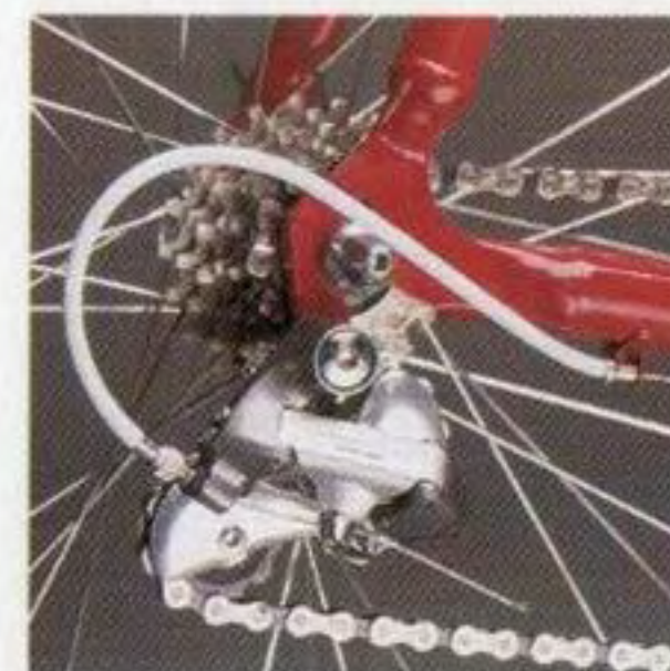
New Shimano 600 Ultegra 7 speed SIS.
