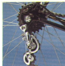
1 - New Huret Jubilee rear Derailleur mechanism.
